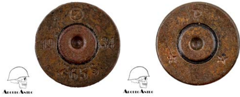
Figura 6.10. Detalle de marcaje de munición 7.65x57mm checa (izquierda) y austriaca (derecha).
